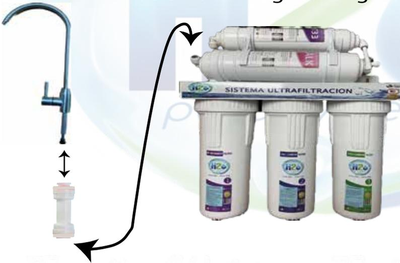
Instalar el grifo en tope o base, una vez instalado colocar acople rapido al grifo, y luego colocar la manguera desde la salida del filtro Alcalino hasta la parte inferior del acople rapido
